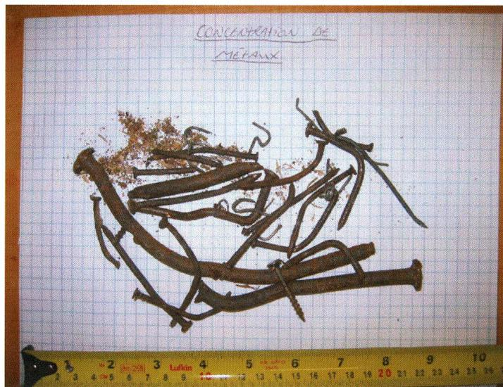
Figure 2. Clous et vis trouvés dans la biomasse
