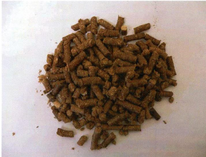
Figure 3. Granules fabriquées avec de la biomasse
